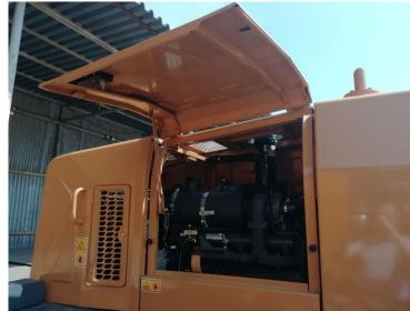
распространенным в отрасли двигателем турбированным Weichai WP6G125E22 мощностью 125 л.с. На **XGMA XG931H** устанавливается двигатель Yuchai
