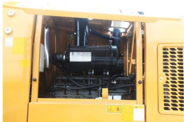
Погрузчик Lonking LG833N оснащается самым распространенным в отрасли двигателем **турбированным** Weichai WP6G125E22 мощностью 125 л.с.
