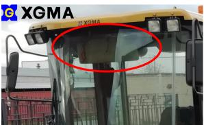
В Lonking LG833N и LiuGong CLG835H в кабине имеется полупрозрачная солнцезащитная шторка, которая позволяет работать даже тогда, когда солнце бьет в глаза. В остальных погрузчиках есть только козырек, который имеет меньшую площадь, а также он закрывает обзор, в отличии от полупрозрачной шторки. В SEM 636D отсутствует даже дешевый солнцезащитный козырек.
