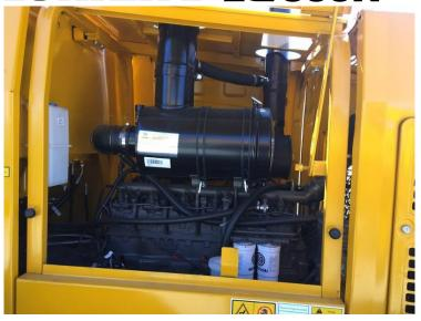
Оба погрузчика оснащаются одинаковым двигателем Weichai WP6G125E22 мощностью 125 л.с.
