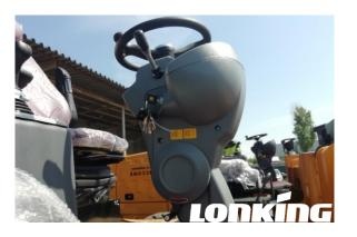
На погрузчиках Lonking LG833N и SEM 636D рулевая колонка имеет регулировку по углу наклона, что делает управление более удобным. На LiuGong CLG835H, SDLG LG933L, XCMG LW300FN и XGMA XG931H рулевая колонка не регулируется.
