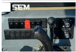
На погрузчиках Lonking LG833N, LiuGong CLG835H, SEM 636D штатная система климат-контроля кондиционером оснащена И осуществляет забор воздуха с улицы через салонный фильтр. Таким образом, климатическая система избыточное создает давление в кабине, что позволяет препятствовать попаданию пыли в салон. Ha Lonking LG833N и SEM 636D ПУЛЬТ управления климатом расположен удобно, рядом с джойстиком, на LiuGong 835H – под потолком.
