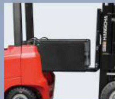
Аккумулятор может быть легко снят сзади, что облегчает его замену (только для свинцово-кислотного аккумулятора)
