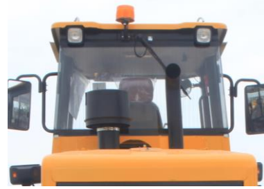
Заднее окно оснащено электроподогревом, стеклоочистителем со стеклоомывателем.
