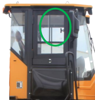
Кабина оператора оснащена защитой при опрокидывании ROPS и защитой от падающих предметов FORS. Обе двери кабины оборудованы форточками в стандартной комплектации.
