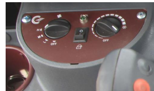
Штатная система климат-контроля оснащена кондиционером и осуществляет забор воздуха с улицы через салонный фильтр.
