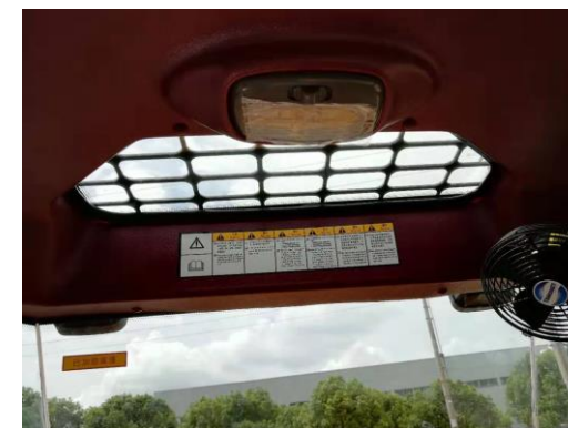
Люк в потолке для контроля работы ковша в поднятом положении
