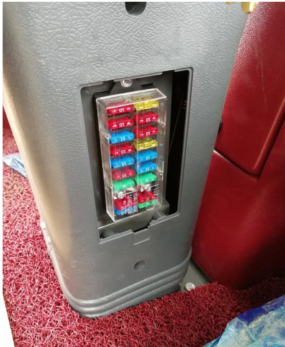
Съемный блок предохранителей для простоты обслуживания
