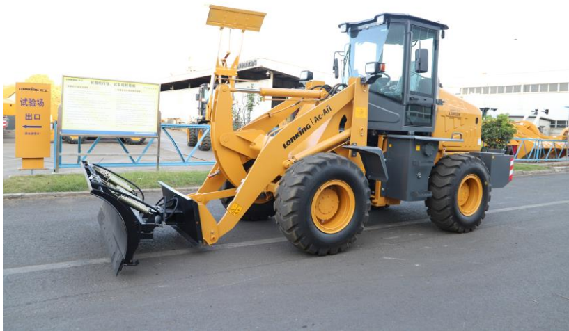
Поворотный отвал для снега Ширина 2200 мм
