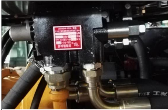
Гидрораспределитель от 2-тонного погрузчика
