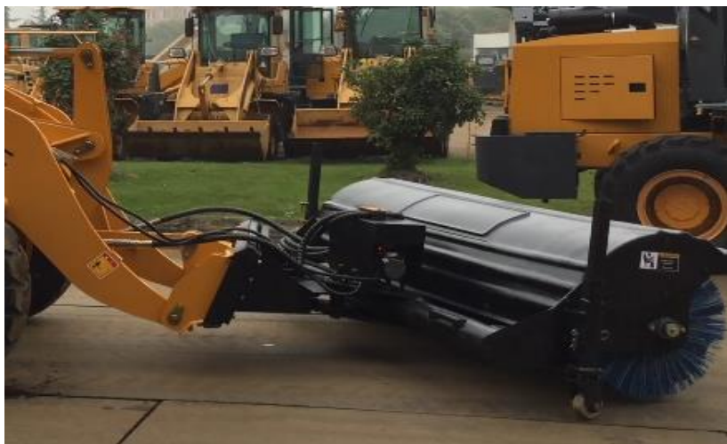
Щетка дорожная с гидроповоротом Ширина 2200 мм, диаметр 800 мм
