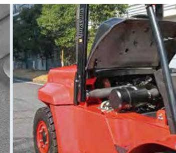
Увеличенный угол открывания капота и увеличение левой и правой боковых панелей капота обеспечивают удобный и быстрый режим обслуживания.
