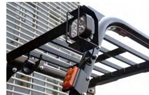
В погрузчике используются светодиодные фонари в качестве осветительных приборов и панорамный ретроотражатель нового типа для обеспечения энергетической эффективности и энергосбережения, а также для значительного повышения и производительности, и срока службы осветительных приборов. Во всех погрузчиках используется материал для защиты окружающей среды, для уменьшения вредного воздействия на окружающую среду.
