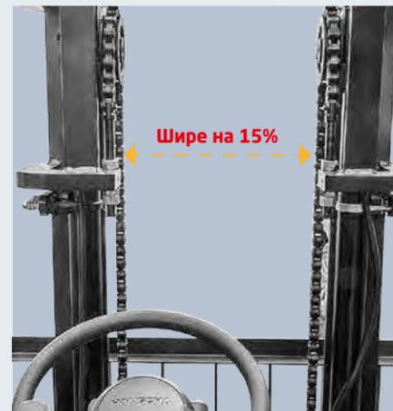
Используется новый тип швеллера. Увеличьте внутреннюю ширину внутренней мачты и расстояние между подъемными цилиндрами. Опускание приборов в кабине водителя значительно увеличит передний обзор; улучшение за счет оптимизации конструкции противовеса.
