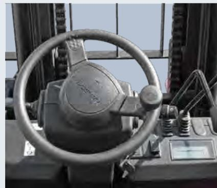
Конструкция рулевого колеса малого диаметра и электрогидравлического реверса, а также комбинированный переключатель автомобильного типа с двумя ручками значительно улучшат комфорт вождения.
