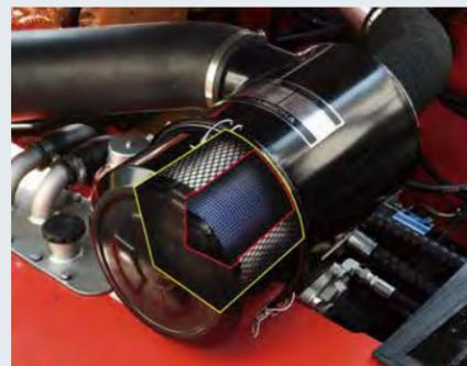
Оптимизированная система впуска и выпуска воздуха всего погрузчика, глушитель выхлопа большой мощности и глушитель шума всасывания с высоким эффектом снизят шум всего погрузчика и уменьшат вибрацию.
