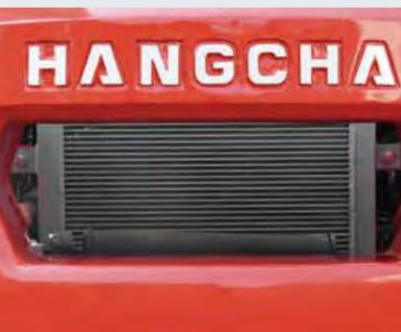
Используется алюминиевый пластинчато-ребристый радиатор с улучшенными характеристиками и более высокой структурной прочностью. Автономный масляный радиатор, оптимизированный канал отвода тепла от масла и воды и двойные вентиляционные отверстия на противовесе могут значительно повысить эффективность охлаждения и надежность работы при перегрузках, а также обеспечить надежную работу двигателя.
